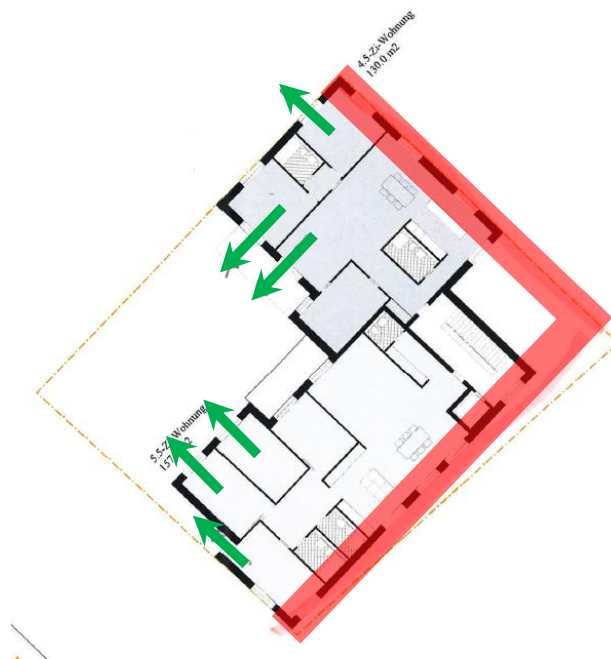
Abb. 9 Regelgeschoss B1; rote Bereiche: IGW-Überschreitungen an Fassade
